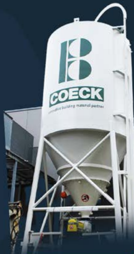
Silo à ciment
