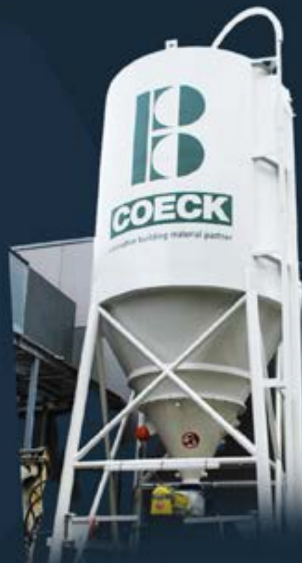
Silo à ciment
